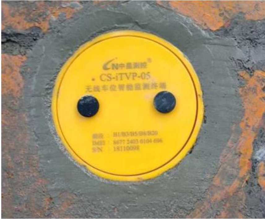
图 8 地埋式终端的安装效果图 (b)
